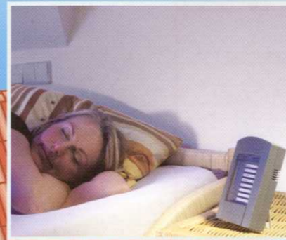
Bei einer Gefahrenauslösung informiert die FlammEx Funk-Zentrale, auf einen Blick, in welchem Raum der Alarm ausgelöst wurde.
